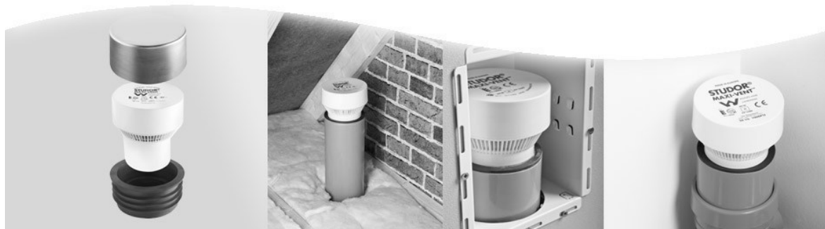
Figura 6.30 – VAA tipo maxi-vent (Capacidade: 32 l/s de ar a 250 Pa)
