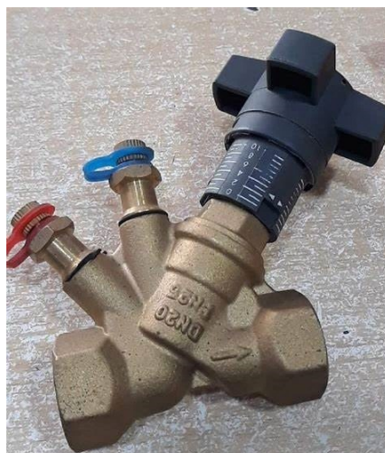
Figura 8.7 – Exemplo de válvula de regulação ou de balanceamento
