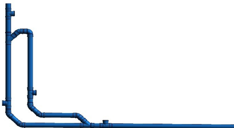
Figura 6.25 – Possíveis localizações para bocas de limpeza
