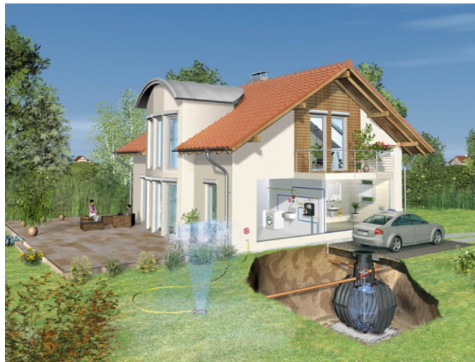
Figura 8.10 – Esquema de um sistema de aproveitamento de águas pluviais num edifício
