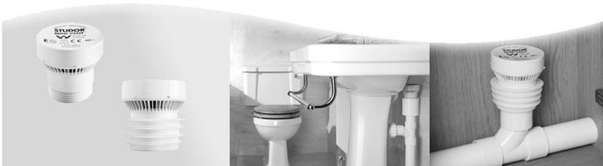
Figura 6.31 – VAA tipo *mini-vent* (Capacidade: 7,5 l/s de ar a 250 Pa)
