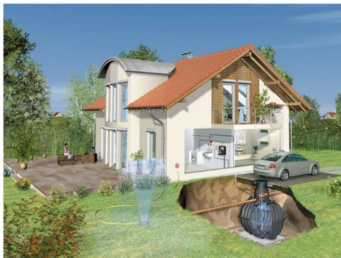
Figura 8.9 – Esquema de um sistema de aproveitamento de águas pluviais num edifício
