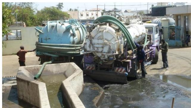
Figura 6.3 – Descarga de camião limpa fossas na obra de entrada de uma ETAR (Strande *et al.*, 2014)
