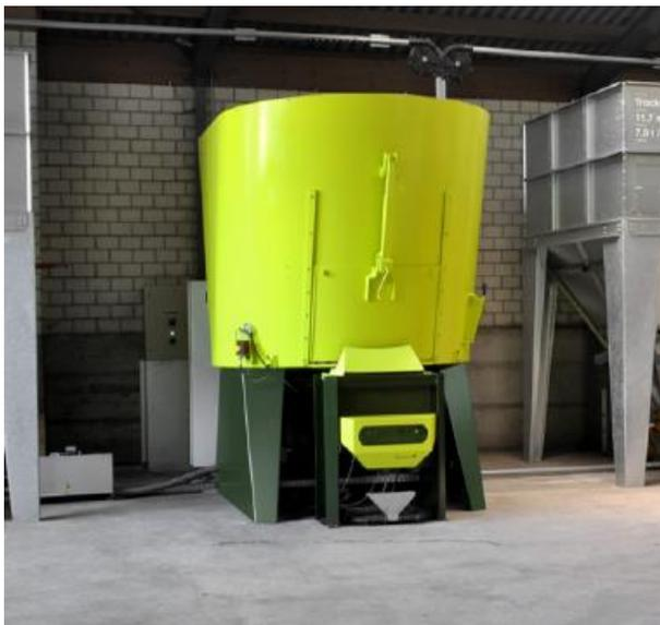
Figura 7.3 – Exemplo de peletizadora (Bioburn®)
