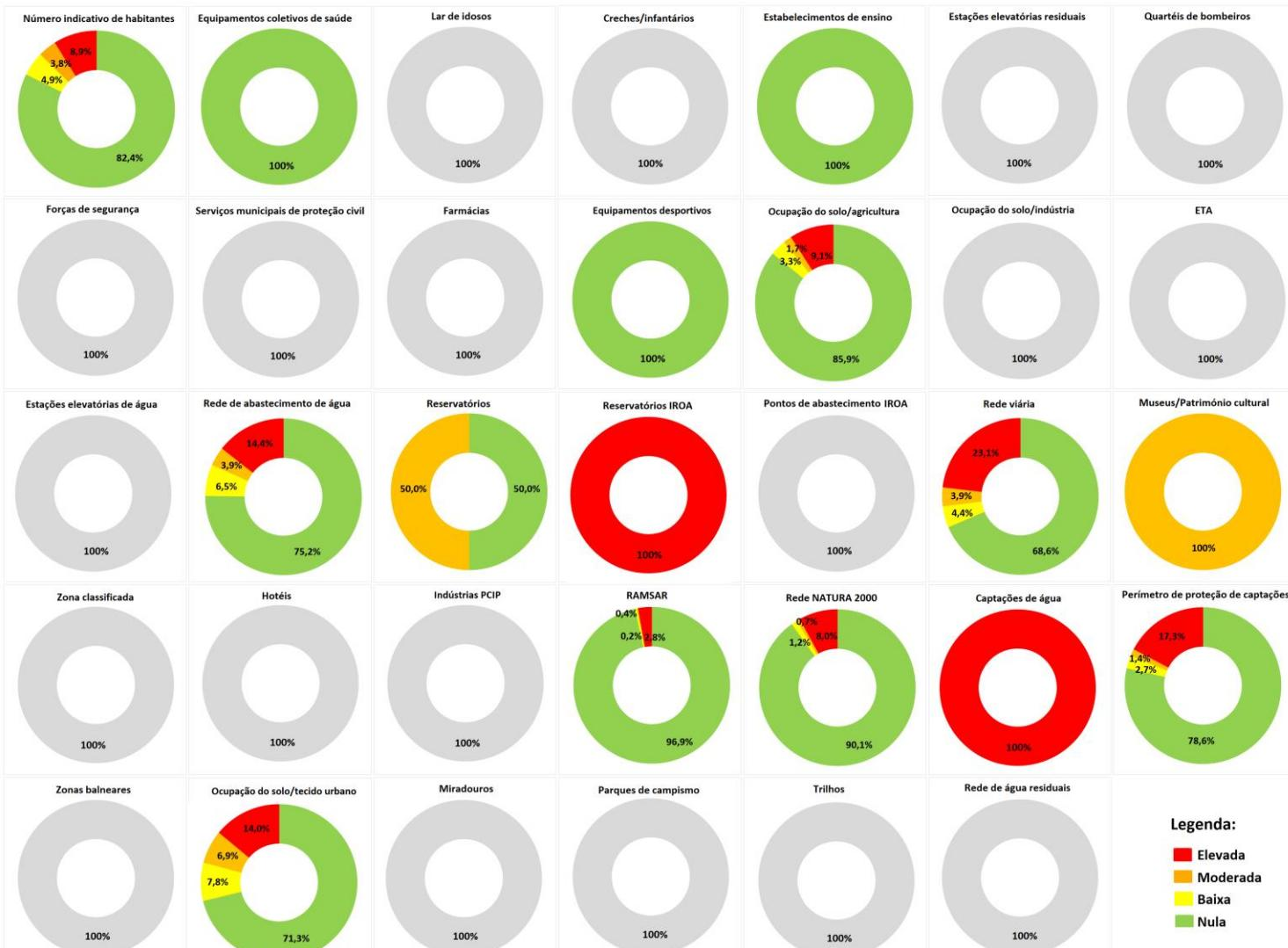
**Figura 5.8 |** Representação gráfica da proporção dos edifícios/elementos vulneráveis por categorias de suscetibilidade a cheias fluviais para a bacia hidrográfica da Ribeira de Agualva (ilha Terceira) (são representados a cinzento os elementos/edifícios vulneráveis onde não existem na bacia hidrográfica).
