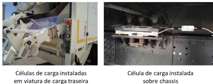
Figura 5 - Instrumentação de viaturas com sistema de pesagem
