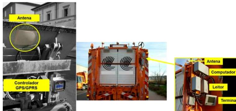
Figura 4 - Instrumentação de viaturas com sistema de leitura de chips RFID
