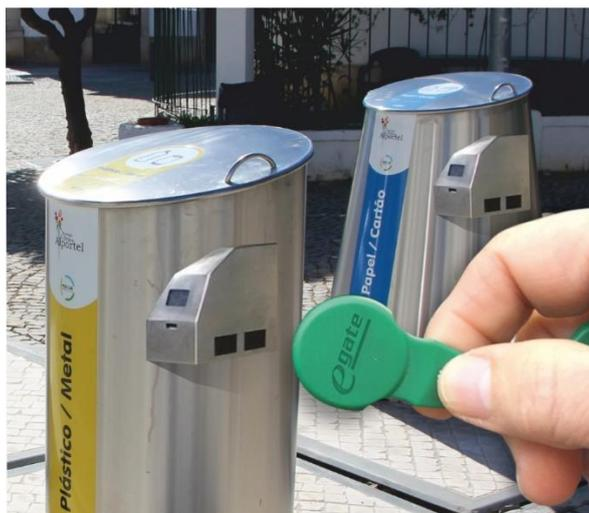
Figura 11 – Chave de acesso aos equipamentos de deposição
