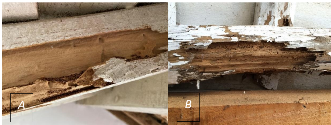
Figura 9- (A) galerias de térmitas vs. (B) galeria de caruncho (Fotos: Rui Martins)
