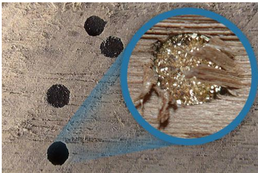
Figura 8-Orifício selado por térmita (Arroz & Borges, 2022)
