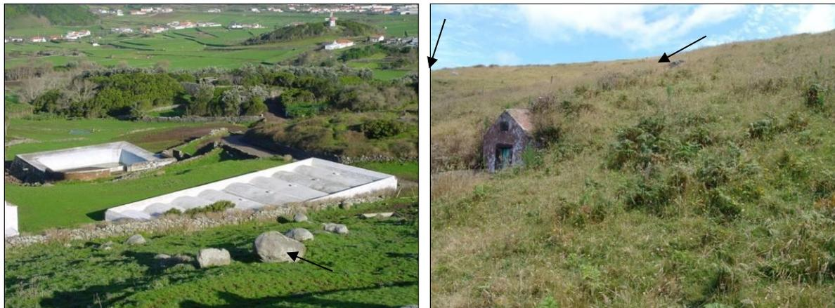
Figura 2.9.19 | Presença de blocos rochosos de grandes dimensões, que poderão afetar os reservatórios e nascentes da Serra das Fontes. As setas indicam a presença de blocos rochosos a montante de reservatórios e de uma nascente.
