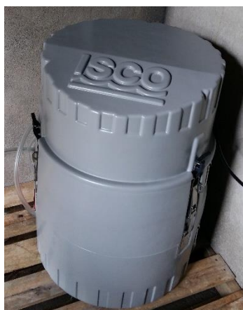
Figura 5.3.: Amostrador automático de recolha de amostras de água para análise laboratorial, marca Teledyne ISCO, modelo 6712.
