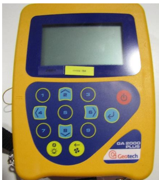
Figura 4.59 | Equipamento GA2000 da Geotechnical Instruments, utilizado na medição da pressão barométrica.
