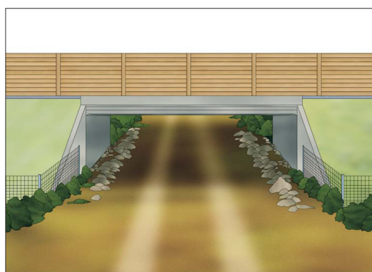
Figura Erro! Não existe nenhum texto com o estilo especificado no documento..23– Esquema ilustrativo de uma passagem inferior com barreiras visuais (Fonte: Iuelle et al. , 2003).
