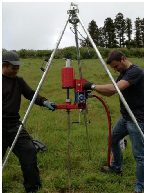
Figura 7 - Penetrómetro Dinâmico Médio. Imagem demonstrativa do ensaio em curso.
