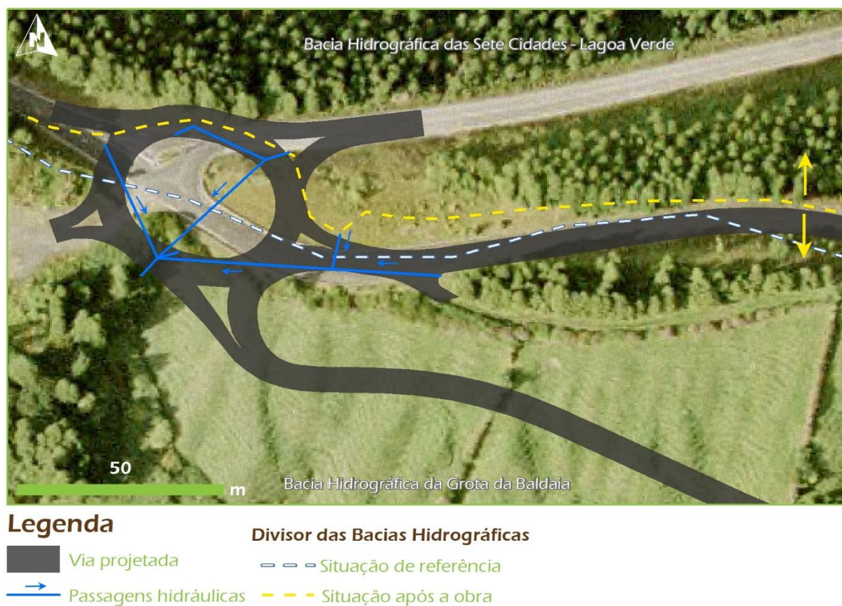
Figura 4.3 | Representação esquemática da localização aproximada do divisor de bacias hidrográficas na situação de referência (linha a tracejado branco) e após a obra (linha a tracejado amarelo)
