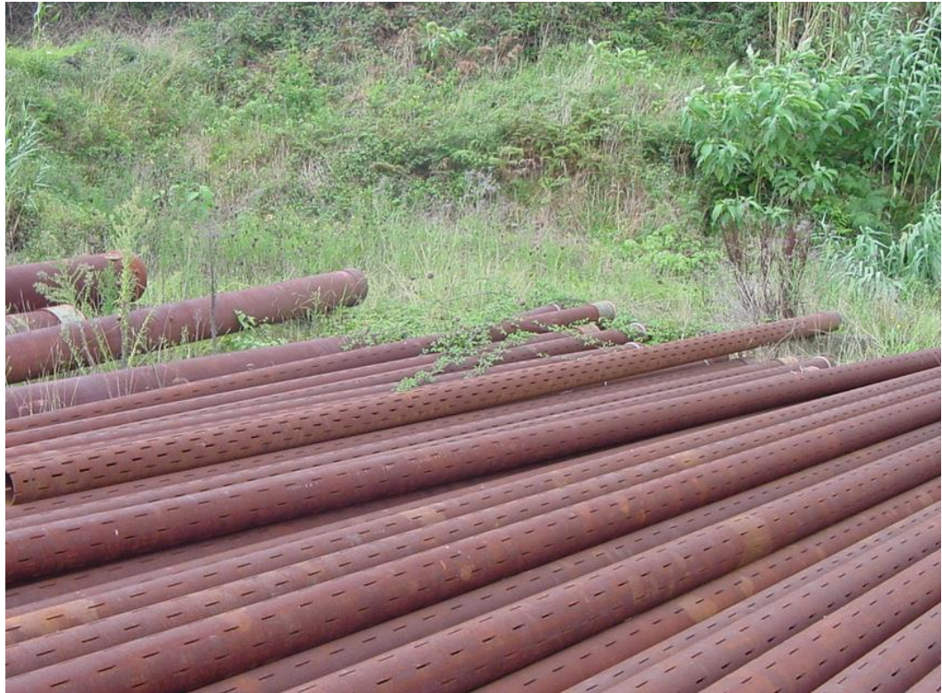
Figura 3.18 – Revestimento ranhurado com 9-5/8”
