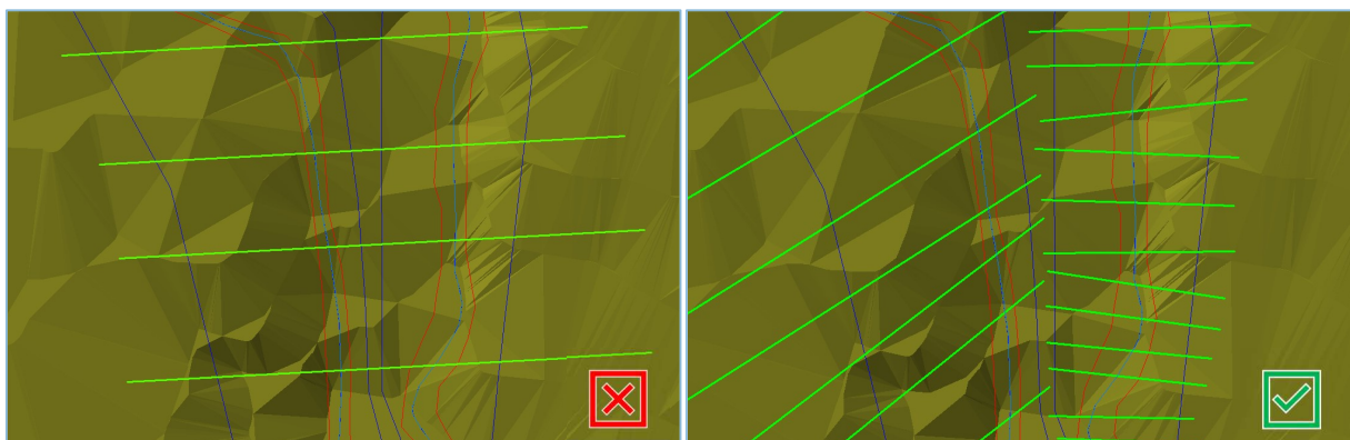
Figura 3.5 | Exemplo de desenho de elementos da camada XSCutLines : linha intersecciona elementos referentes a duas linhas de água (imagem da esquerda); e linhas interseccionam os elementos referentes apenas a uma linha de água (imagem da direita)
