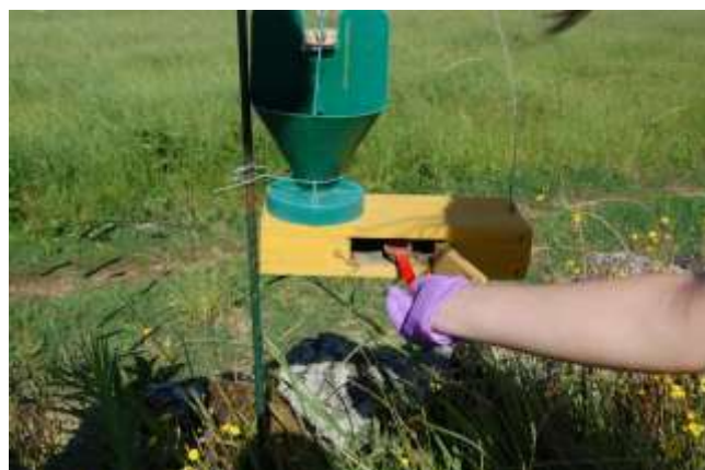
Figura 1.23 - Colocação numa armadilha do tipo Ellisco modificada do inóculo com os esporos do fungo M. robertsii .
