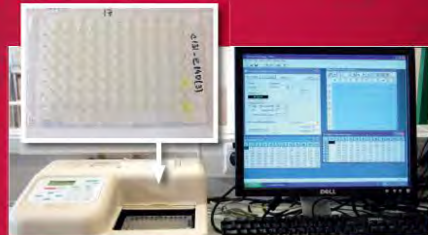
Figura 6 – Placa utilizada no teste ELISA e equipamento para a leitura dos resultados.
