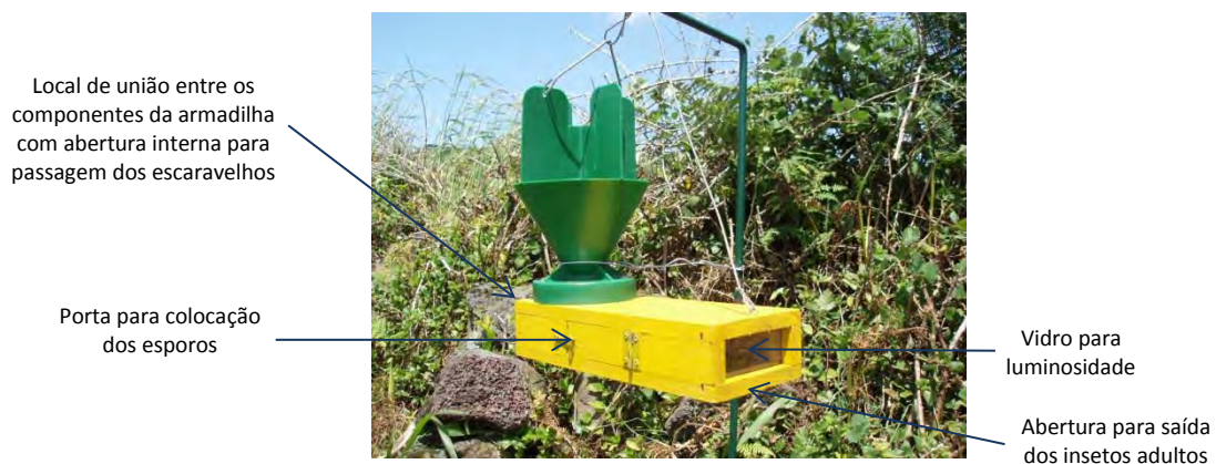
Figura 37 - Armadilha do tipo Ellisco modificada para autodisseminação dos esporos do fungo M. robertsii .
