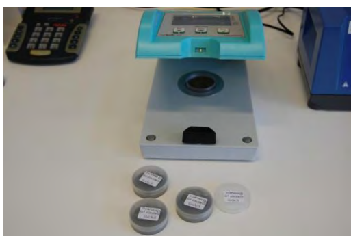
Figura 30 – Aparelho de medição de humidade.
