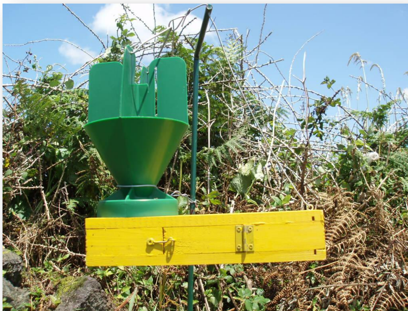
Figura 7 – Armadilha do tipo Ellisco modificada utilizada para a autodessimação de M. robertsii .
